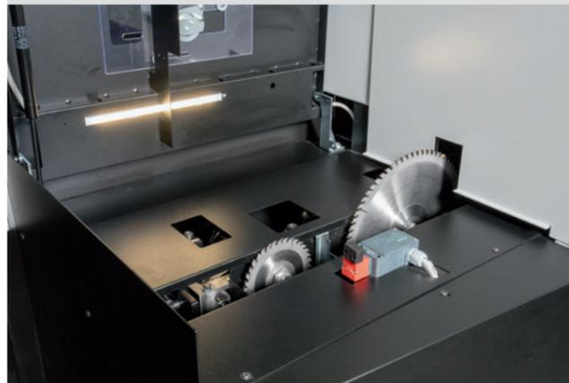
**SK** **Zóna pre výmenu pilového kotúča** je umiestená na strane ovládacieho panelu a je prístupná z hornej časti. Výmena nástroja sa prevádza pomocou jediného kľúča a je jednoduchá, bezpečná a rýchla. Jednotka pilového kotúča je prepojená s odsávaním prachu pre väčšiu účinnosť sania.
