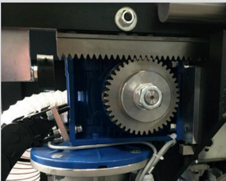
**SK** Polohovanie posúvača prebieha vždy pod priamym dohľadom riadiacej jednotky stroja, ktorá pre zistenie polohy používa **magnetický čítací systém**. Presne rozmiestnené ozubnice zaisťujú presný a paralelný posúvací pohyb. Posuvný stôl pod posúvačom je vybavený samostatnými nepoháňanými valčekmi, aby nedošlo k poškrabaniu panelov s jemnými povrchmi.
