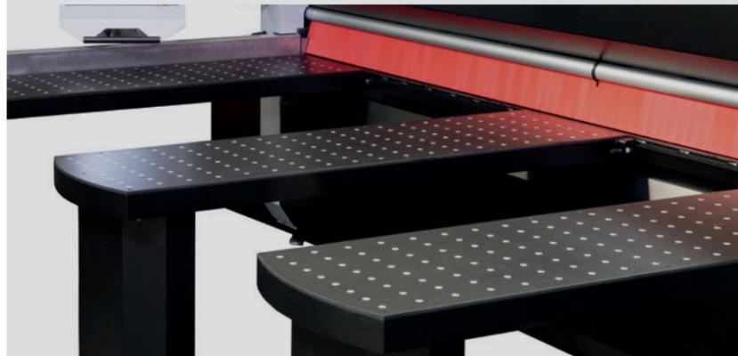
**SK** Standardný stroj je vybavený troma **prednými nastaviteľnými stolmi**, z nich dva sú pohyblivé na kolieskach pre rýchly a ľahký pohyb v bočných smeroch a sú pokryté fenolickým materiálom odolným proti poškrabaniu. Na požiadanie **môžu byť stoly prefukované** pre ľahký pohyb ťažkých panelov alebo stohu panelov.
