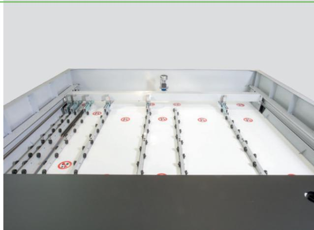
**SK** Pritlačný posúvač je vybavený **5 klieštinami na KR 32 a 6 klieštinami na KR 43**, zatiaľ čo pneumatický tlak klieštin možno nastaviť zvonka stroja tak, aby zodpovedal rezanému materiálu.
